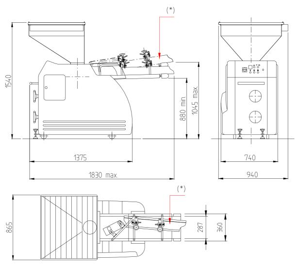
(\*) DISPOSITIVO ARROTONDATORE (IN OPZIONE) SHAPING DEVICE (OPTIONAL)
